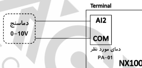
شکل ۵-۶ سیم‌کشی دستگاه برای استفاده از PID داخلی به منظور کنترل پروسه
