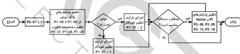
شکل ۵-۱۵ فلوجارت تنظیم دستگاه در روش کنترل حلقه بسته برداری CLVC
